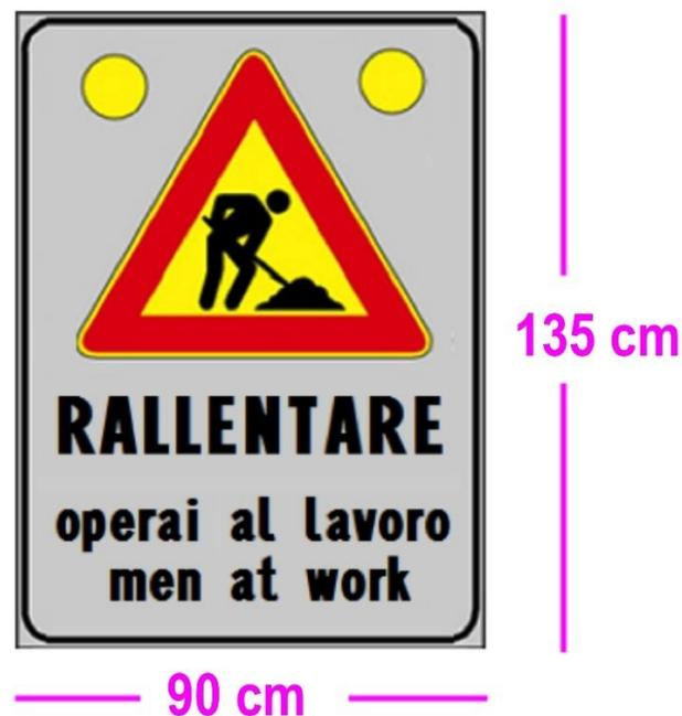
Figura "ridotta" - Applicabile per cantieri di durata < 24h o situazioni particolari ove non risulti posizionabile la figura di dimensioni normali
