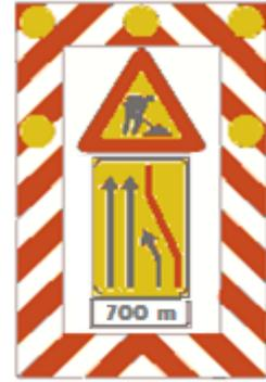
Per quanto possibile le regole di segnalamento sono le stesse dei cantieri fissi, nel senso che è previsto un segnalamento in anticipo e un segnalamento di localizzazione. I segnali si spostano in maniera coordinata all'avanzamento delle attività programmate in modo che siano separatamente visibili.
